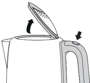
2. Druk op de ontgrendelingstoets voor het deksel om het deksel te openen.
