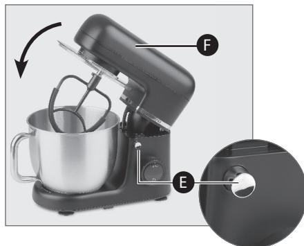
**Hinweis:** Ist der Antriebsarm (F) nicht in der unteren Position, lässt sich das Gerät nicht in Betrieb nehmen. Sollte der Antriebsarm (F) nicht korrekt verriegelt sein und daher während des Betriebes nach oben klappen, stoppt das Gerät umgehend den Betrieb. In beiden Fällen erscheint die Fehlermeldung „E :01“ blinkend im Display.
