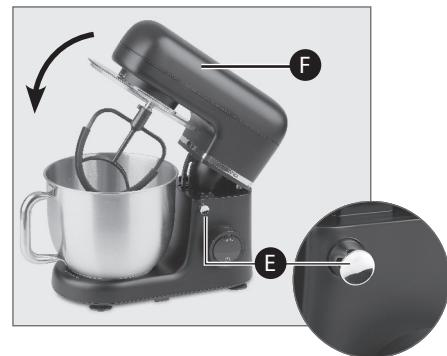
**Let op:** Als de aandrijfarm (F) niet in de onderste positie staat, kan het apparaat niet werken. Als de aandrijfarm (F) niet correct is vergrendeld en daardoor tijdens de werking omhoogklapt, stopt het apparaat onmiddellijk met werken. In beide gevallen begint op het display de foutmelding "E :01" te knipperen.
