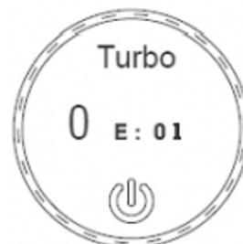
Duw in dit geval de aandrijfarm volledig naar de onderste positie en zorg ervoor dat hij in deze positie goed vergrendeld is. Als de foutmelding verschijnt terwijl het apparaat werkt,
