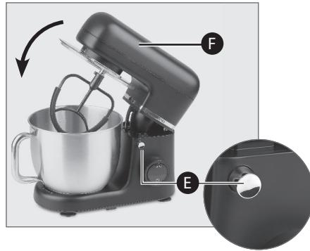
**Remarque :** si le bras d'entraînement (F) n'est pas abaissé, l'appareil ne peut pas être mis en service. Si le bras d'entraînement (F) n'est pas correctement verrouillé et qu'il se relève lors du fonctionnement de l'appareil, ce dernier s'arrête immédiatement. Dans les deux cas, le message d'erreur « E :01 » clignote sur l'affichage.
