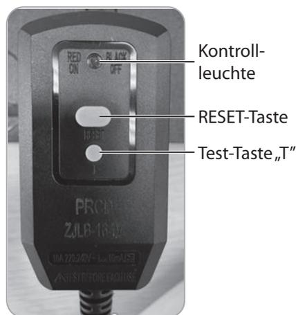
**Hinweis:** Die Fehlerstromschutzeinrichtung wird jedes Mal aktiviert, wenn der Netzstecker aus der Steckdose gezogen wird, d. h. bei einem erneuten Anschluss an das Stromnetz muss zunächst wieder die RESET-Taste gedrückt werden, um die Warmluftbürste am 4-Stufenschalter (G) einschalten und betreiben zu können.
