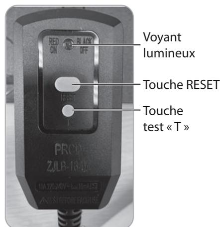
**Remarque :** le dispositif de protection à courant résiduel est activé à chaque fois que le connecteur est débranché de la prise secteur, c'est-à-dire qu'à chaque fois que l'appareil est à nouveau branché, il faut d'abord appuyer sur la touche RESET pour pouvoir allumer et utiliser la brosse soufflante au niveau du commutateur à 4 positions (G).
