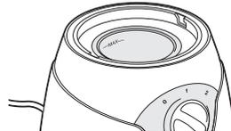
3. Drehen Sie den Aromabehälter etwas im Uhrzeigersinn, damit er verriegelt. Die Verriegelung muss spürbar einrasten.
