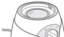
3. Tournez légèrement le récipient d'arôme dans le sens des aiguilles d'une montre pour le verrouiller. Le dispositif de verrouillage doit s'enclencher.
