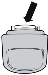
3. Draai de terugslagklep (zie pijl) naar links en verwijder deze.
