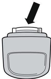
3. Tournez le clapet de retenue (voir flèche) dans le sens contraire des aiguilles d'une montre et enlevez-le.
