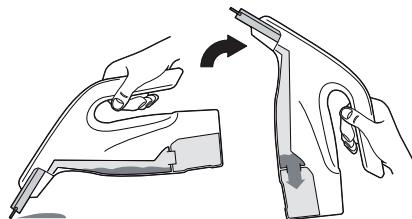
Als u dit niet doet, komt er water in de ventilator. U hoort dan een zoemend geluid en er zal water uit de bodem van het toestel ontsnappen.
