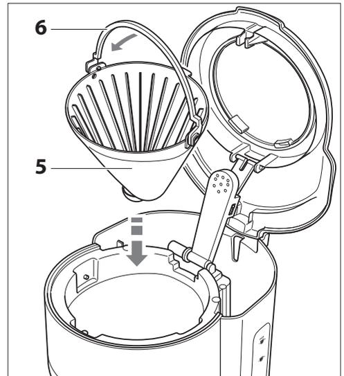
**i** Mit dem Henkel wird der Filterträger gleichzeitig verriegelt, sodass der Ablauf zur Kanne einwandfrei funktioniert. Andernfalls lässt sich der Deckel **7** nicht korrekt schließen und Kaffee kann über den Deckel der Kaffeekanne auslaufen.
