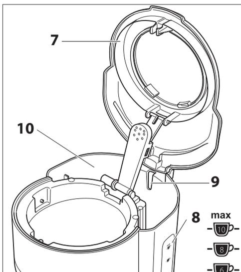
**i** U kunt de hoeveelheid water die in de koffiemachine zit aan beide zijden aflezen via de waterpeilindicator.
