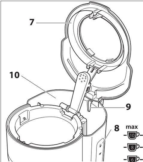
**i** Die eingefüllte Wassermenge können Sie über die beidseitige Wasserstandsanzeige ablesen. Die MAX-Markierung **8** darf nicht überschritten werden.
