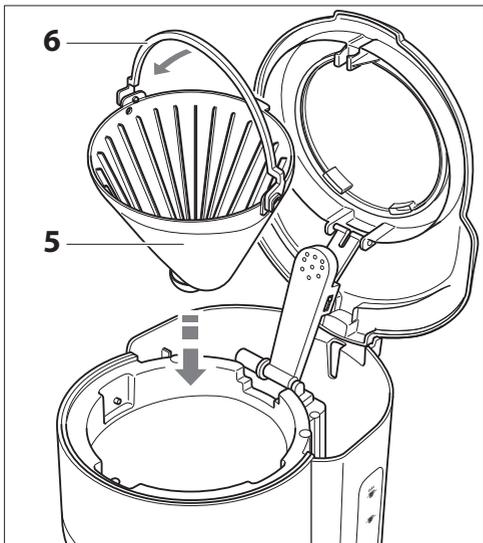
**i** De handgreep vergrendelt tegelijkertijd de filterdrager zodat de afvoer naar de kan zonder problemen werkt. Anders sluit het deksel **7** niet goed en kan er koffie over het deksel van de koffiekan lopen.
