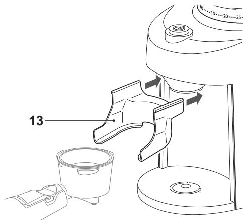
Der Siebträgerhalter **13** muss dazu rechts und links in eine Führung bis zum Anschlag geschoben werden.
