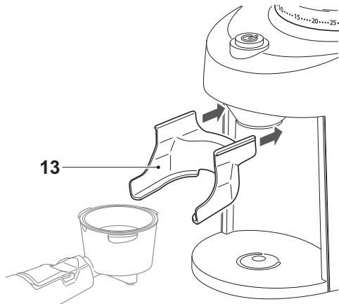
Le support de porte-filtre **13** doit, pour cela, être inséré dans son logement jusqu'à la butée gauche et droite.
