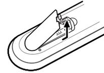
Retirez le couvercle des piles au dos de la télécommande et introduisez deux piles AAA. Assurez vous que les polarités (+ et -) sont respectées.
