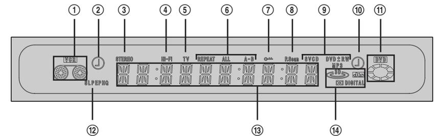
**①** Signale si une cassette VHS est insérée dans le magnétoscope.
