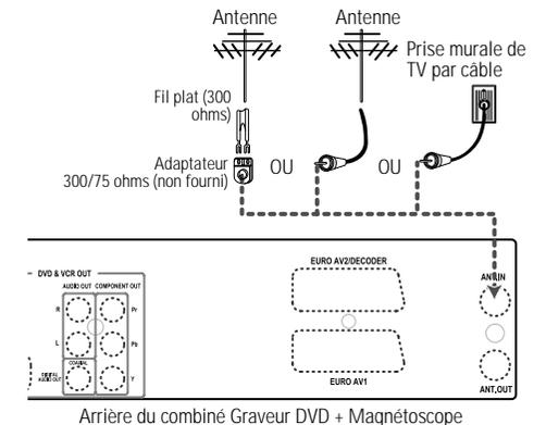
Si le câble est raccordé à votre téléviseur sans boîtier décodeur ou adaptateur, dévissez le câble de votre TV et branchez-le sur la prise RF IN (FROM ANT.) du panneau arrière du combiné Graveur DVD + Magnétoscope.
