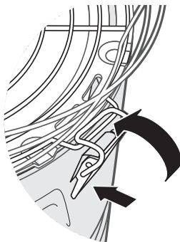
10. Verrouillez la grille à l'aide des deux pinces 8. La grille et la coque extérieure sont solidement assemblées.
