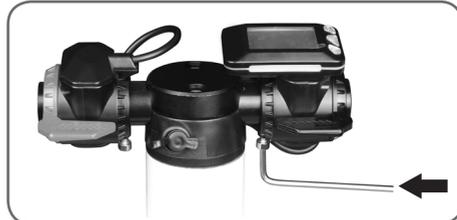
Installez le guidon et serrez les vis. La poignée gauche est marquée de la lettre L et la poignée droite de la lettre R.
