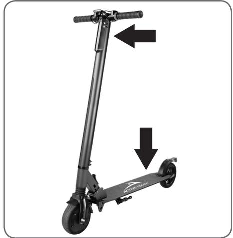
**AVERTISSEMENT:** Avant de conduire l'E-Scooter, vérifiez toujours que le mécanisme de verrouillage est complètement verrouillé." Avertissement: Avant de conduire l'E-Scooter, vérifiez toujours que le mécanisme de verrouillage est complètement verrouillé.
