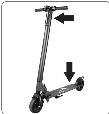
**WAARSCHUWING:** Voordat u gaat rijden op de E-Scooter altijd controleren of het vergrendelmechanisme volledig is vergrendeld.
