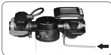
Plaats de handvatten en draai de schroeven aan. Het linkerhandvat is gemarkeerd met de letter L en het rechterhandvat is gemarkeerd met de letter R.
