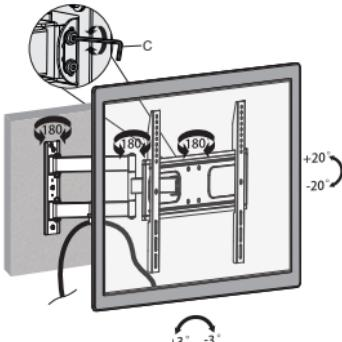
Desserrer la vis de réglage pour faire pivoter le téléviseur dans la position désirée et la serrer à nouveau. Il est également possible de faire pivoter le téléviseur pour une flexibilité de visualisation maximale sans qu'il soit nécessaire de desserrer les vis.
