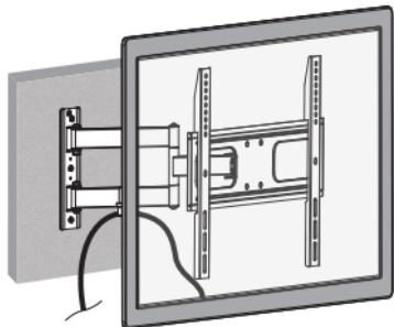
Plaats de kabels in het kabel geleidingssysteem om de bedrading verborgen en georganiseerd te houden.
