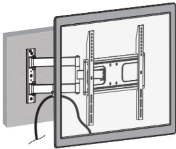
Insérer les fils dans le système de gestion des câbles pour maintenir les câbles dissimulés et organisés.
