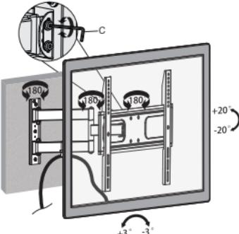
Draai de schroef los om de TV in de gewenste positie te draaien en draai deze weer vast. Het is ook mogelijk om de TV te draaien zonder dat u schroeven los hoeft te draaien.
