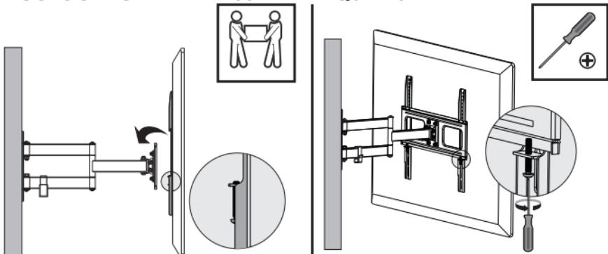
Serrez les deux boulons à l'aide d'un tournevis Philips approprié pour fixer le support.
